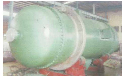
卧式换热器 Horizontal heat exchanger
