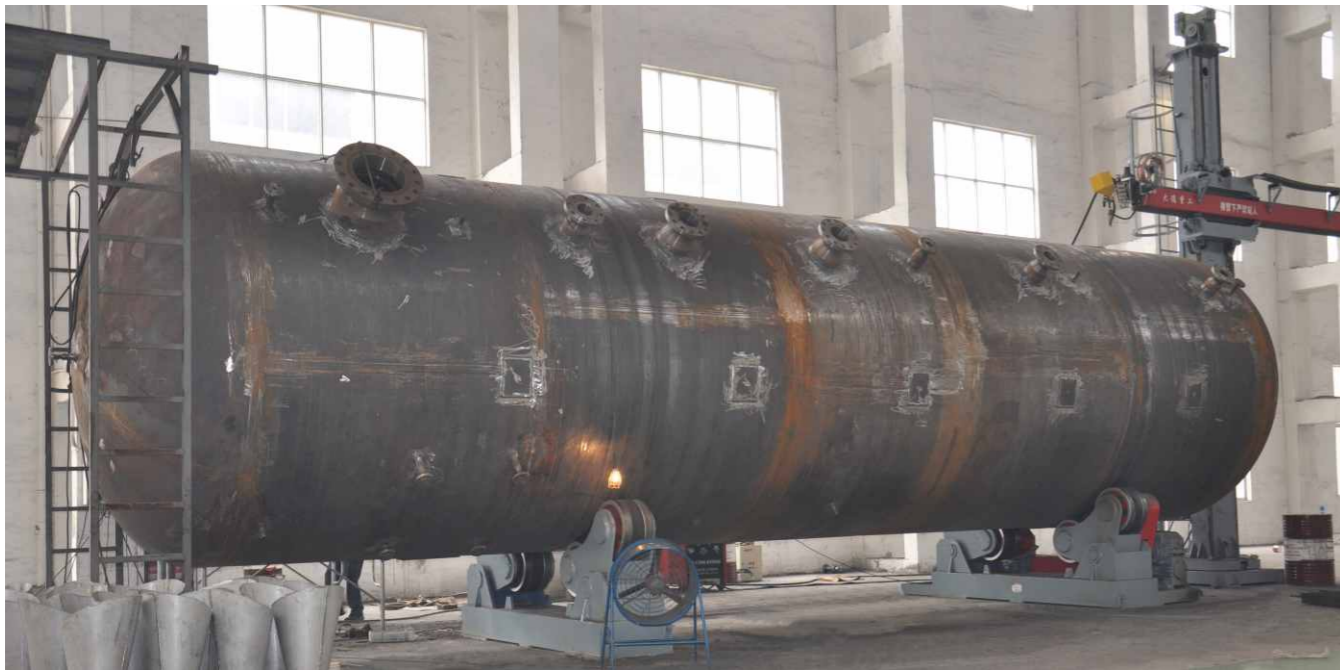
蓄热器(10-200m³) Heat accumulator (10-200m³)
